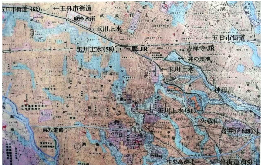
図14 玉川上水は境浄水場で五日市街道から離れて、甲州街道(上北沢)に至る。五日市街道(境浄水場)から甲州街道上北沢まで約8・6km。○内数字は標高m
